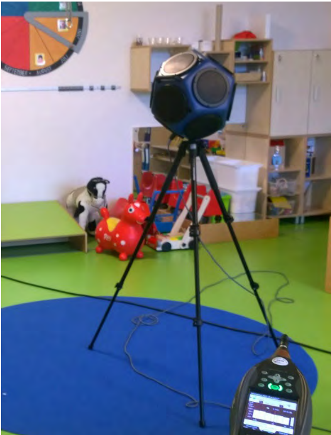
Abbildung 37: Dodekaeder-Lautsprecher zur Messung der Nachhallzeit
